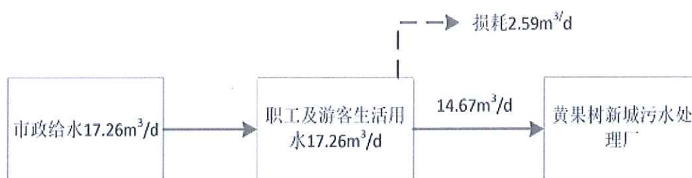
图 2-1 项目水平衡图 (m 3 /d)
