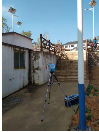
G2 污水处理站东侧废气监测点
