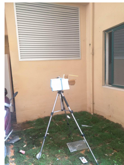
G4 8#楼地下车库废气监测点
