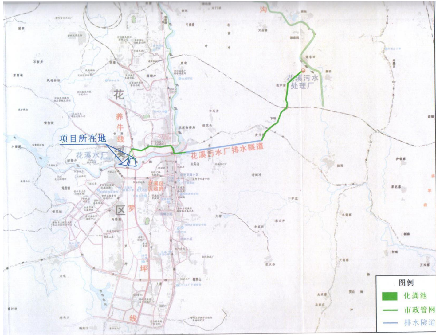
项目污水外排管线图
