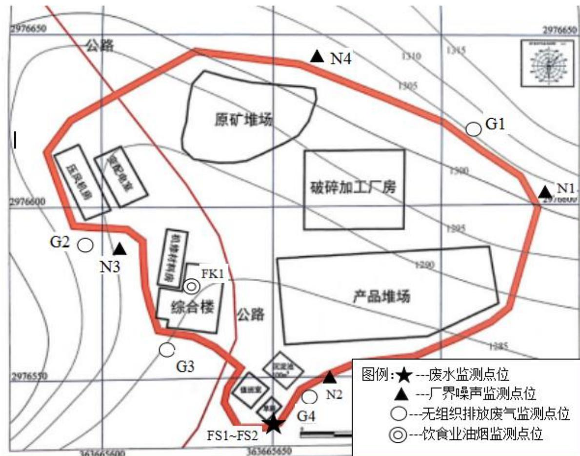
图2 项目平面布置及监测点位图
